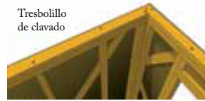
Clavado de solera de enrase en tresbolillo a lo largo de la solera
