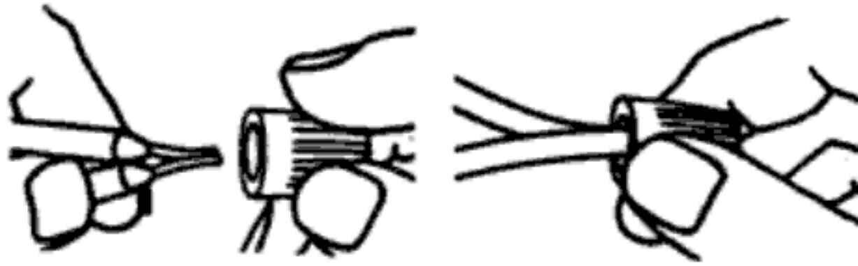
Fig. 1-18 Colocación correcta de una tuerca de empalme.
