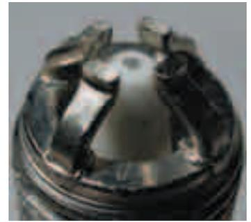
↑ Figura 1.45. Bujía con varios electrodos de masa.
