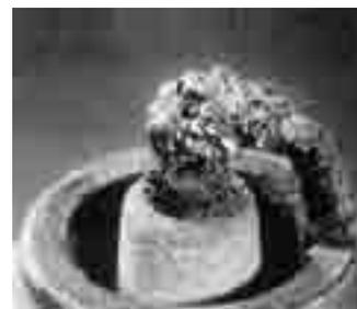
↑ **Figura 1.52.** Bujía con electrodos soldados por fusión.
