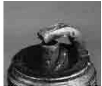
↑ Figura 1.53. Bujía con rotura del pie del aislador.
