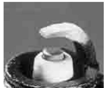
↑ Figura 1.55. Bujía con desgaste por quemadura de electrodos.
