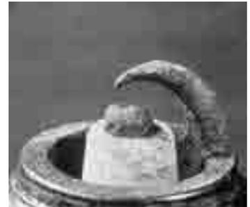
↑ Figura 1.54. Bujía con desgaste de electrodos.
