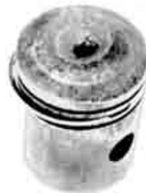
↑ Figura 1.33. Daños ocasionados por autoencendido en un pistón.
