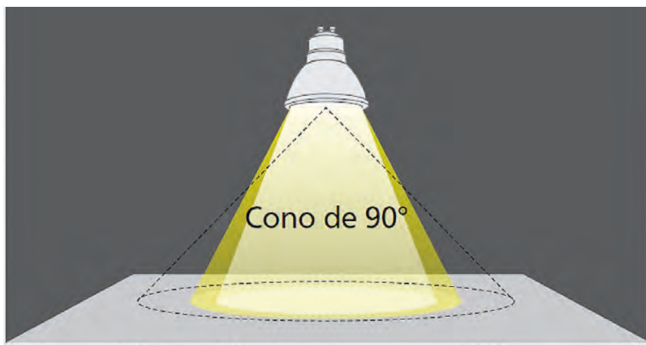
Figura 9. Lúmenes útiles medidos dentro de un cono de 90^\circ .
