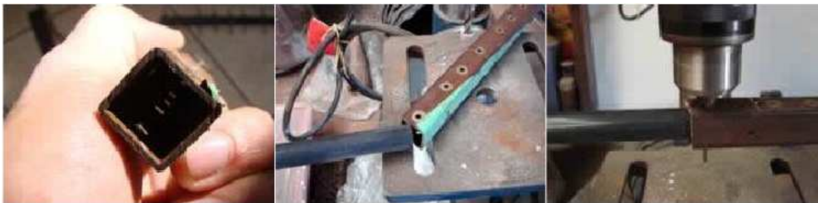
Artefacto para perforaciones Insertando el caño en el artefacto Efectuando perforaciones de prueba.
