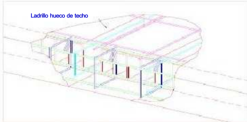
Vigas y Losa (aligerado)
