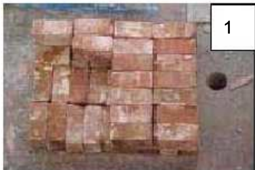
1 Unidades de Albañilería (ladrillos) Los ladrillos deben humedecerse a fin que no tomen el agua de la mezcla y lograr una buena adherencia
