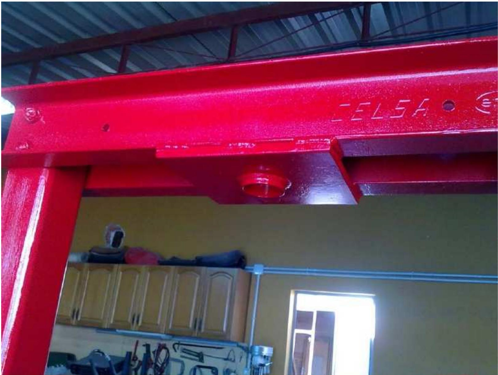
El siguiente paso fue unir las dos vigas transversales inferiores para que tengan mayor rigidez y para ello utilice dos trozos de 105 x 100 x 100 mm de tubo sobrante de los pilares verticales.
