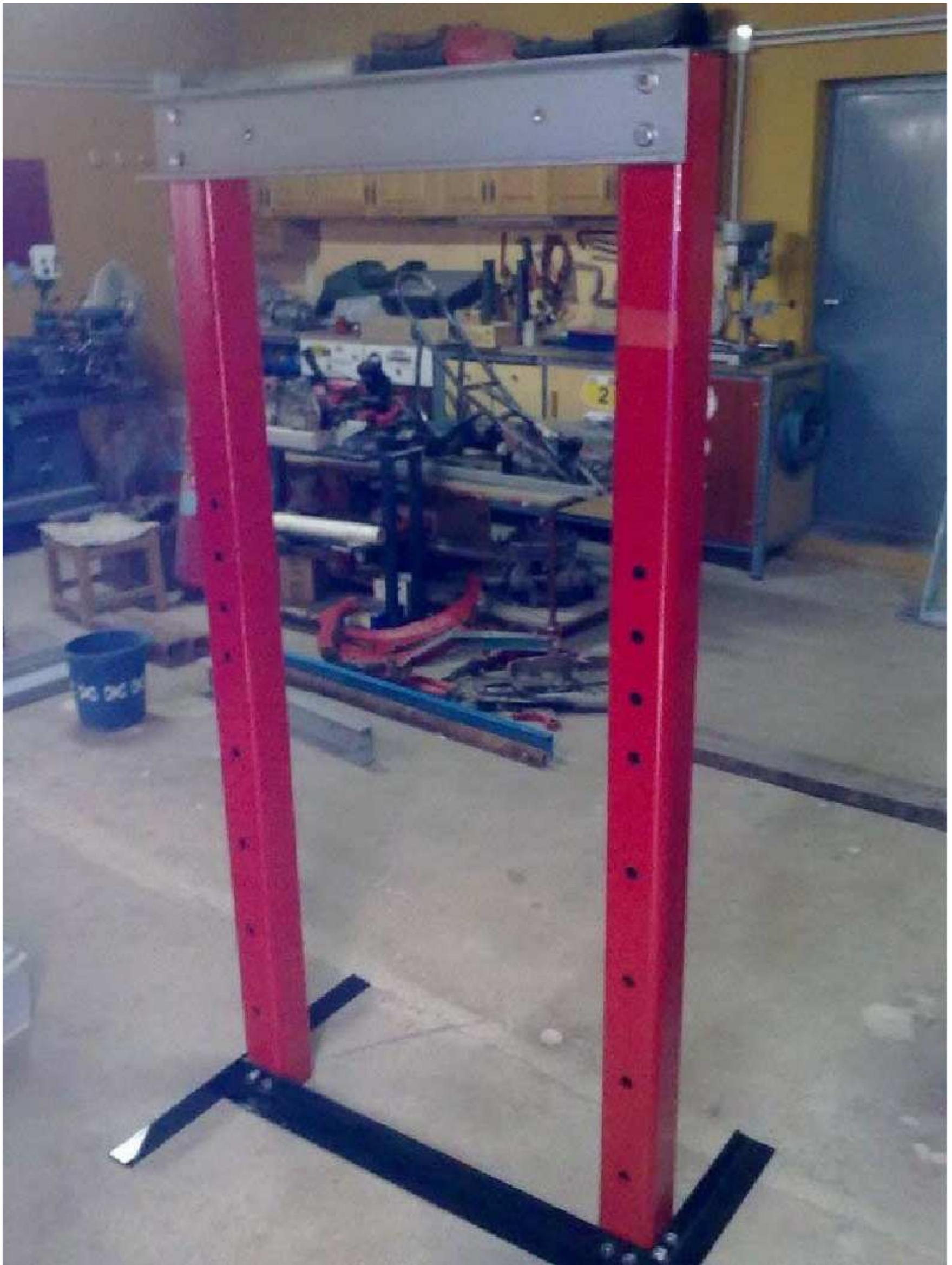
Se han colocado unos angulos de apoyo de 600 x 50 x 50 mm y un angulo central de 900 x 50 x 50 mm para mantener paralelos los pilares verticales y que el conjunto sea estable.
