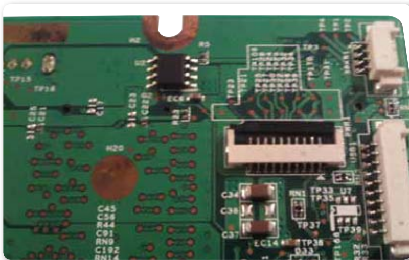
Figura 15. La mayoría de los botones en una notebook se comunican con el motherboard a través de conectores especiales para el envío de señales.
