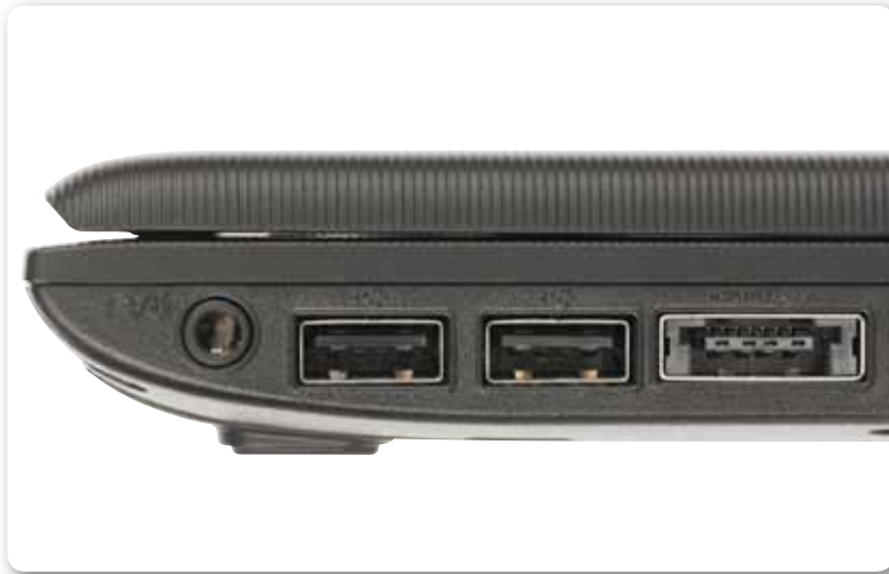
Figura 6. La versión actual del puerto USB en notebooks es la 3.0, pues asegura mayor capacidad de transferencia que la 2.0.
