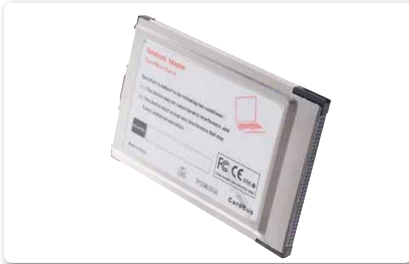
Figura 4. Las PC Card permitían añadir nuevas funciones a una computadora portátil.
