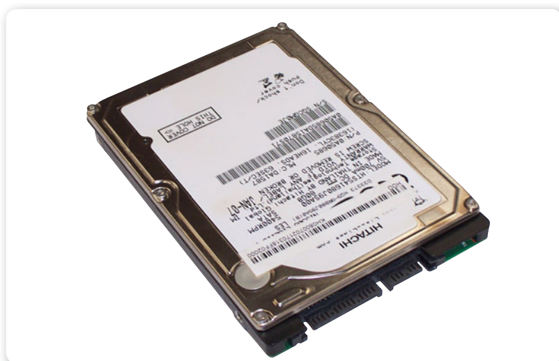
Figura 12. El disco duro en un equipo portátil está colocado generalmente en la base de la PC, sujeto a un caddy (receptáculo).
