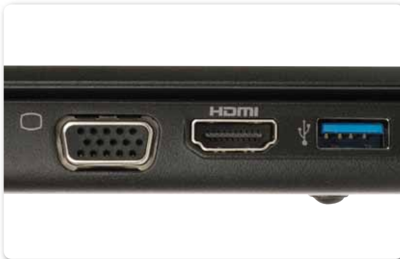
Figura 9. El puerto HDMI es hoy un estándar en la industria de las PC portátiles, ya que integra audio y video en una sola interfaz.
