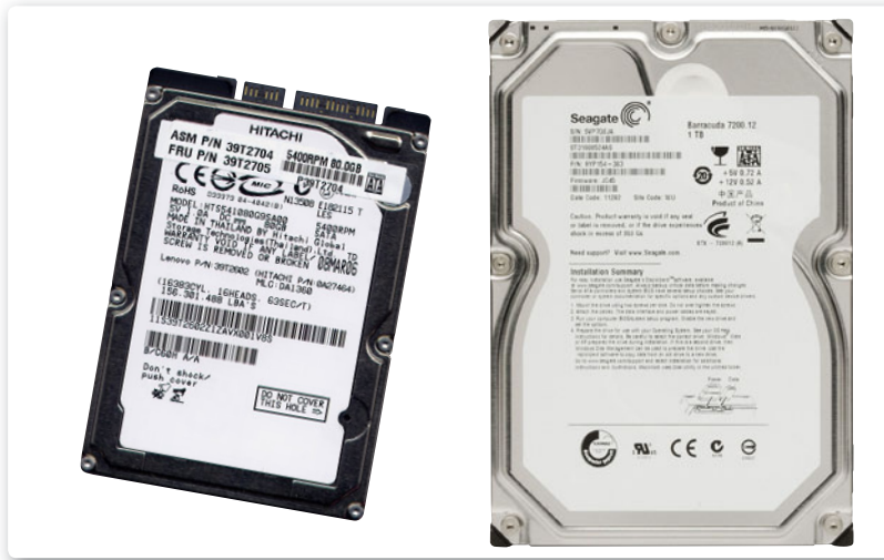
Figura 13. El tamaño estándar de las unidades de disco duro para portátiles es de 2,5 pulgadas, en comparación con las 3,5" de un disco para desktop.
