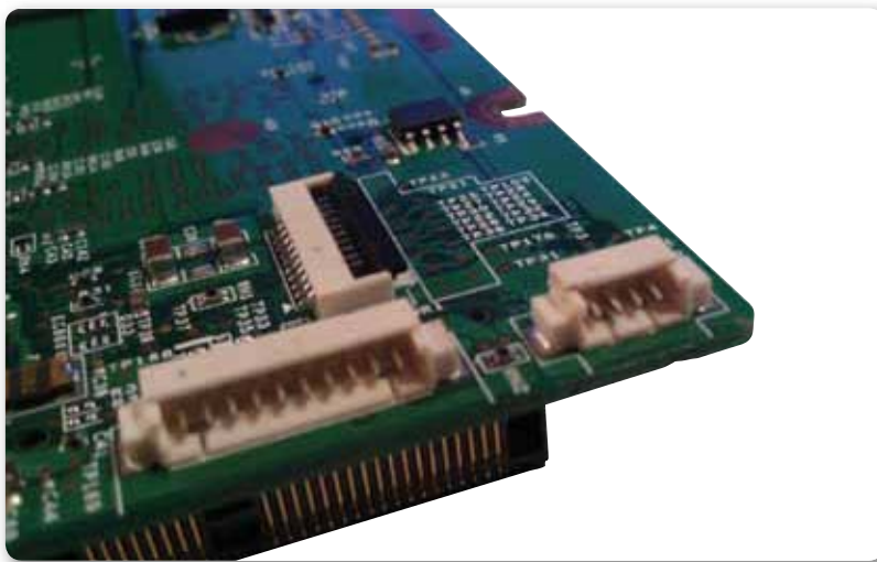
Figura 14. Las ranuras SPKR soportan cuatro contactos de conexión, dos para cada uno de los altavoces.
