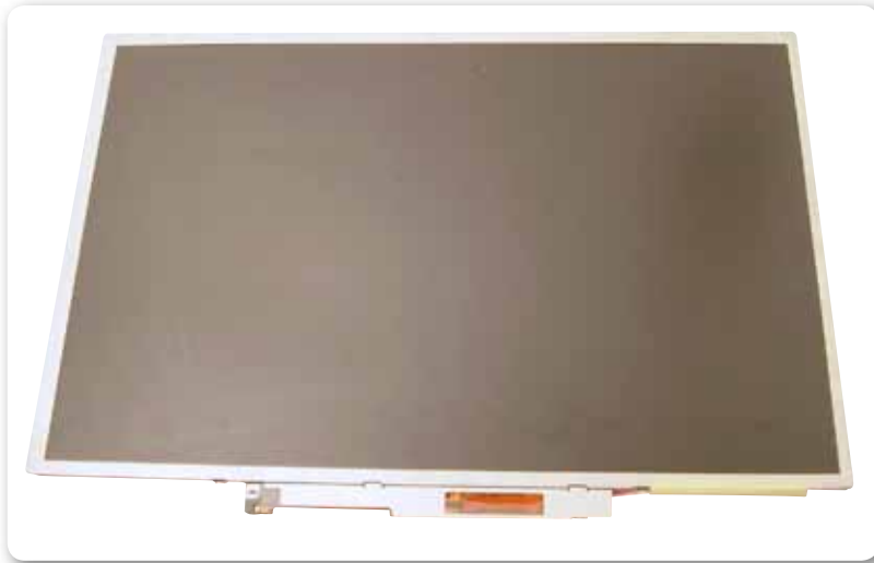
Figura 2. El panel LCD de una notebook está constituido por una CCFL y un inversor de pantalla.
