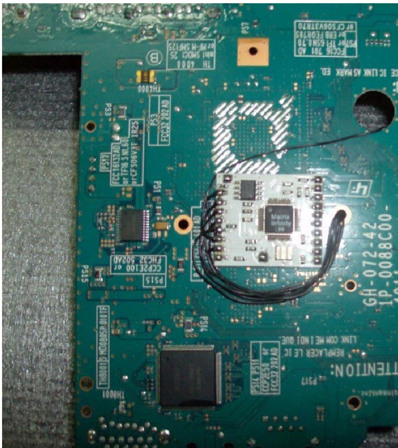
El cableado terminado de la parte de abajo (en la foto me faltaba el punto RST ,que se soldo despues)
