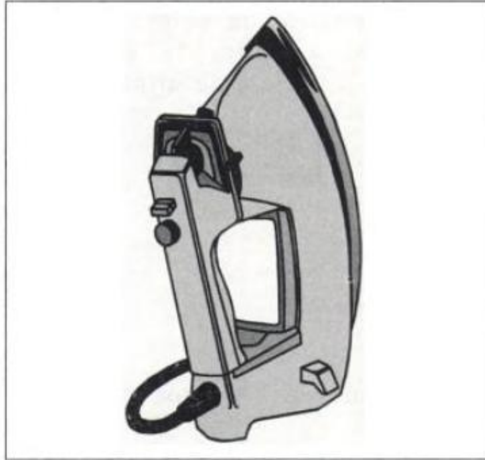
LA PLANCHA: REPRESENTA UNA CARGA TIPO RESISTIVA.
