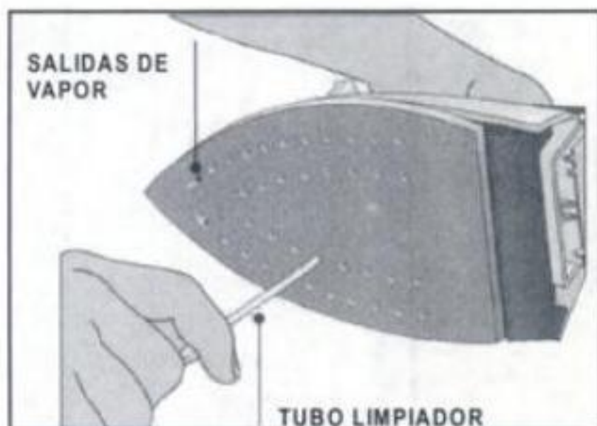
RETIRO DE IMPUREZAS DE LOS TUBOS O SALIDAS DE VAPOR POR MEDIO DE PALILLOS DE DIENTES O UN TUBO LIMPIADOR.
