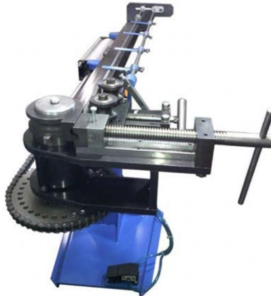
Figura 26. Dobladora de tubos semiautomática.
