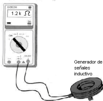
2.52 Medición de resistencia a la bobina captadora
