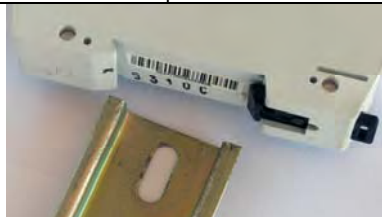
El anclaje de estos dispositivos se realiza mediante Perfil Omega (Perfil DIN)
