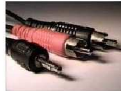
Extremos de un cable con conectores RCA y plug macho en sus extremos.
