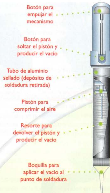
Figura 12.18. Estructura interna de un desoldador mecánico
