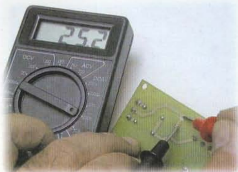
Figura 12.25a. Cortando un circuito impreso para medir corriente
