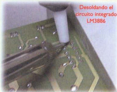
Figura 12.27. Cambiando los circuitos integrados de potencia
