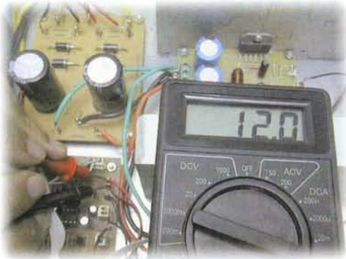
Figura 12.24. Midiendo los voltajes de CC en diferentes puntos del aparato
