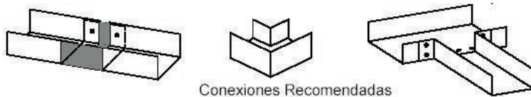
Continuidad de los componentes metálicos del sistema
