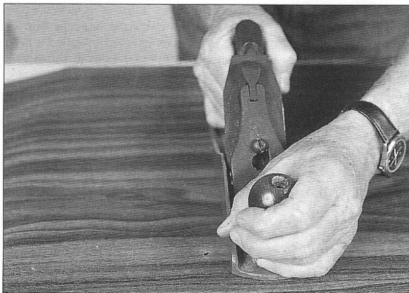
*El cepillo se utiliza siguiendo siempre la dirección de las fibras de la madera. Si se utiliza como en la fotografía, puede bloquearse y estropear la superficie de la pieza de madera*
