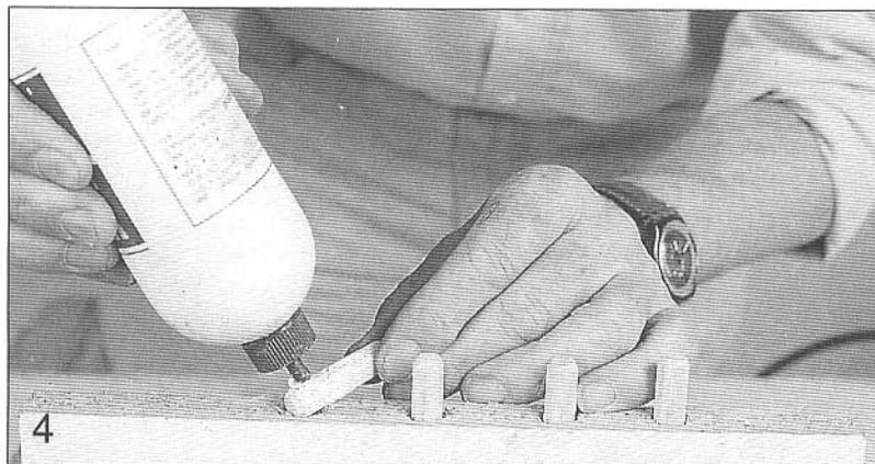
*Aplicaremos el adhesivo sobre las clavijas y las colocaremos en los agujeros de la primera pieza de madera, de forma que la mitad quede dentro y la otra mitad fuera*
