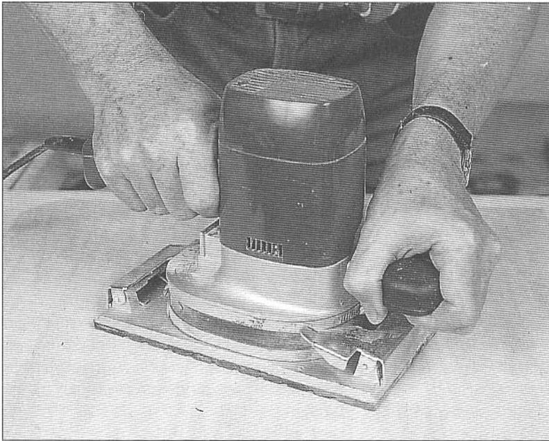
*La lijadora orbital permite lijar y pulir rápidamente grandes superficies planas o ligeramente curvadas*
