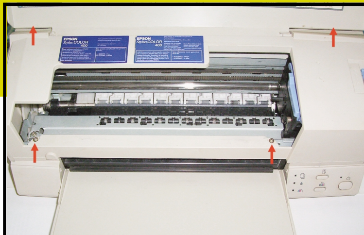
LOS DOS TORNILLOS QUE VEMOS DEBAJO DE LA TAPA, SUMADOS A LOS OTROS DOS QUE ESTAN EN LOS LATERALES DE LA BANDEJA DE ENTRADA, SON LOS QUE SOSTIENEN LA CUBIERTA QUE NOS DA ACCESO A LOS COMPONENTES FUNDAMENTALES DE LA IMPRESORA.
