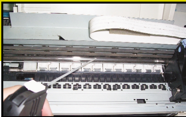
APLICANDO UN REMOVEDOR DE PARTICULAS Y UN BUEN LUBRICANTE A LO LARGO DE LA CORREDERA, GARANTIZAMOS EL ADECUADO DESPLAZAMIENTO DE LOS CABEZALES. TAMBIEN ES MUY IMPORTANTE EL BUEN ESTADO DE LA CORREA DENTADA.
