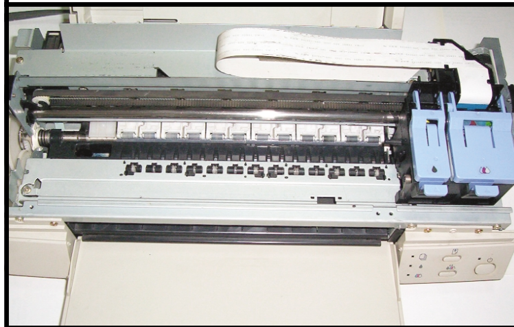
LOS DOS TORNILLOS QUE VEMOS DEBAJO DE LA TAPA, SUMADOS A LOS OTROS DOS QUE ESTAN EN LOS LATERALES DE LA BANDEJA DE ENTRADA, SON LOS QUE SOSTIENEN LA CUBIERTA QUE NOS DA ACCESO A LOS COMPONENTES FUNDAMENTALES DE LA IMPRESORA.
