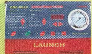
Funciones de lavado, inyección autodiagnóstico, control de tiempo y emulación de condiciones de trabajo del vehículo.
