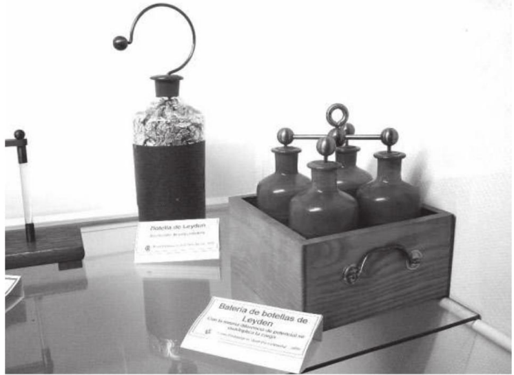
Diferentes modelos de la Jarra de Leyden, capacitor elemental del año 1747.
