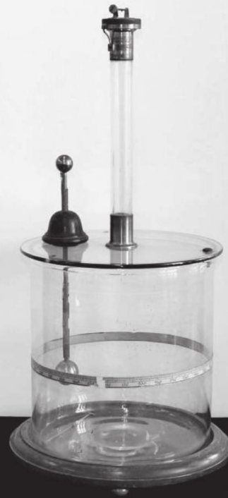
Balanza de torsión utilizada para determinar la ley de Coulomb. Las cargas eléctricas generan una fuerza de torsión que es medida según el ángulo de torsión formado.
