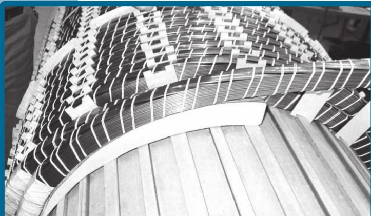
Conductor traspuesto utilizado en bobinados de hélice continua, debido a que no se necesita hacer transposición entre las espiras.
