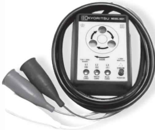
Medidor de secuencia de fases con un secuencímetro.
