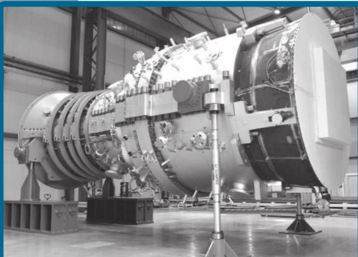
Turbina Siemens SGT5-8000H de 375 MW.
