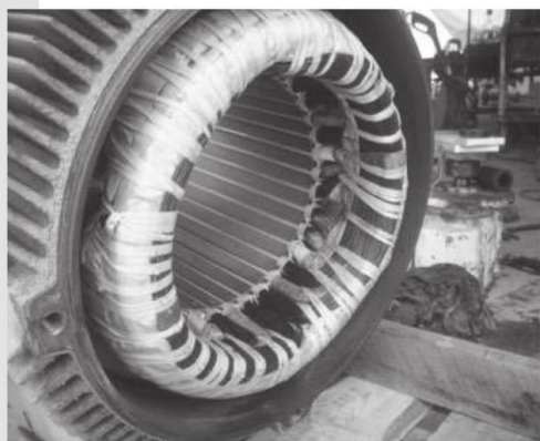
Imagen del bobinado de estátor montado en las ranuras y con todos los aislantes colocados, además de su tratamiento de barniz.
