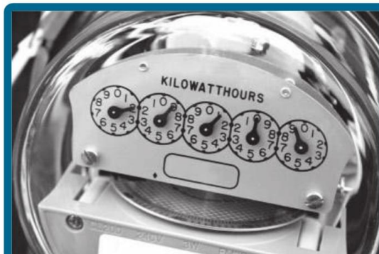
Los medidores de energía mecánicos utilizan piezas y principios físicos, como la inducción y la generación de campos magnéticos, para su funcionamiento.
