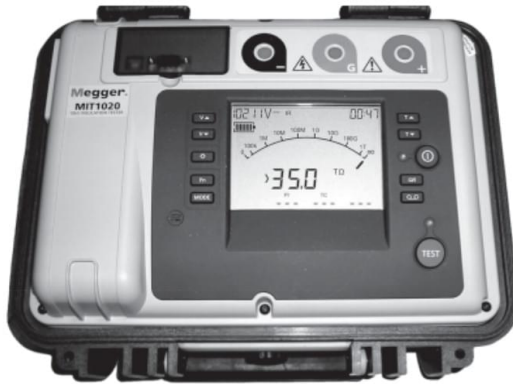
Equipo para medición de resistencia de aislación entre cada bobinado y tierra.
