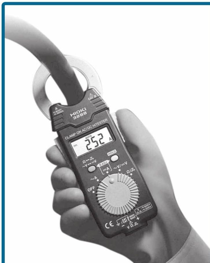
Método utilizado para medir la corriente sobre un conductor que esté consumiendo corriente.
