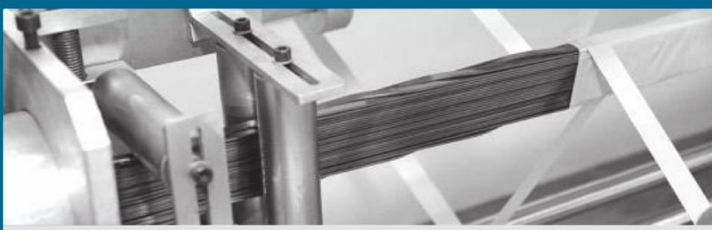
Planchuela de cobre aislada con cintas de papel en las máquinas de forrado. De acuerdo al porcentaje de solapamiento entre las diferentes tiras, se logra modificar el espesor final.
