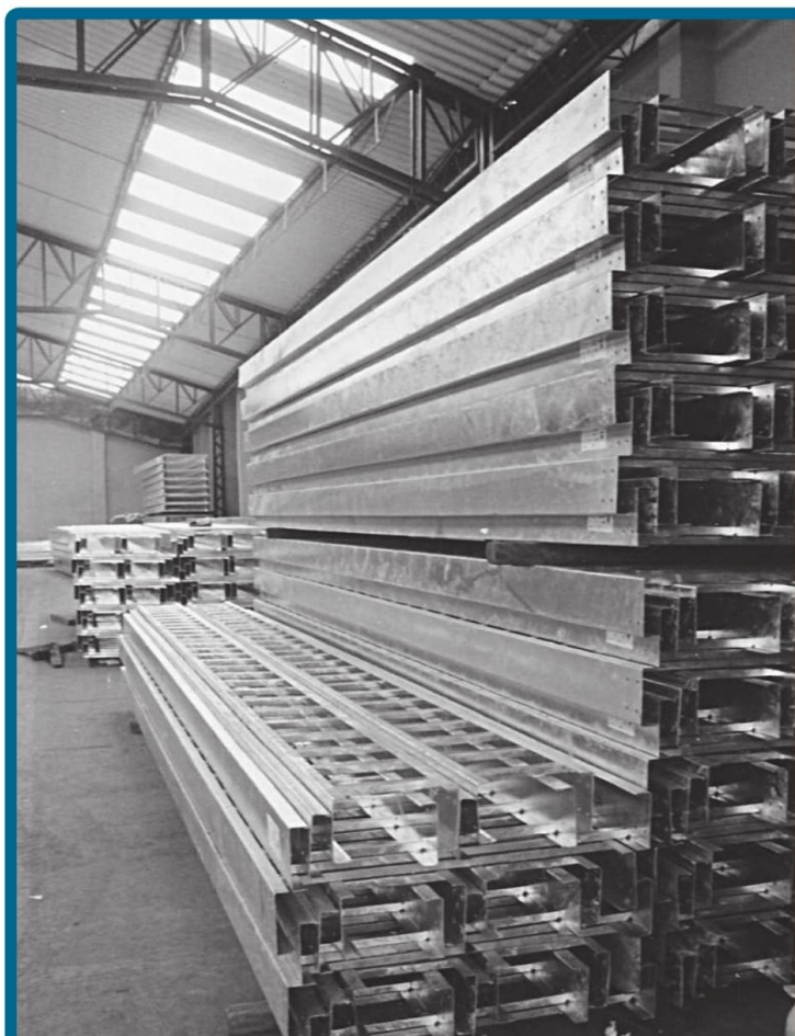
Típicas bandejas perforadas. Las perforaciones preformadas se utilizan para los conectores de unión de las cañerías.
