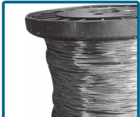
El cable llamado desnudo por no tener recubrimiento se utiliza para las instalaciones de descarga a tierra. Este es uno de los que menos aleación debe tener para ser un buen conductor de descarga.
