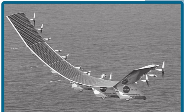
Avión solar no tripulado Helios, de la Nasa, con 130 metros de envergadura y 14 hélices, diseñado para vigilar la alta atmósfera por meses.
