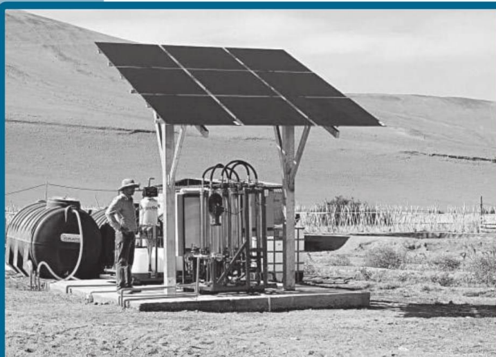
La baja del costo y mejora en el rendimiento de los paneles fotovoltaicos permite instalar plantas desalinizadoras de agua en zonas desérticas.
