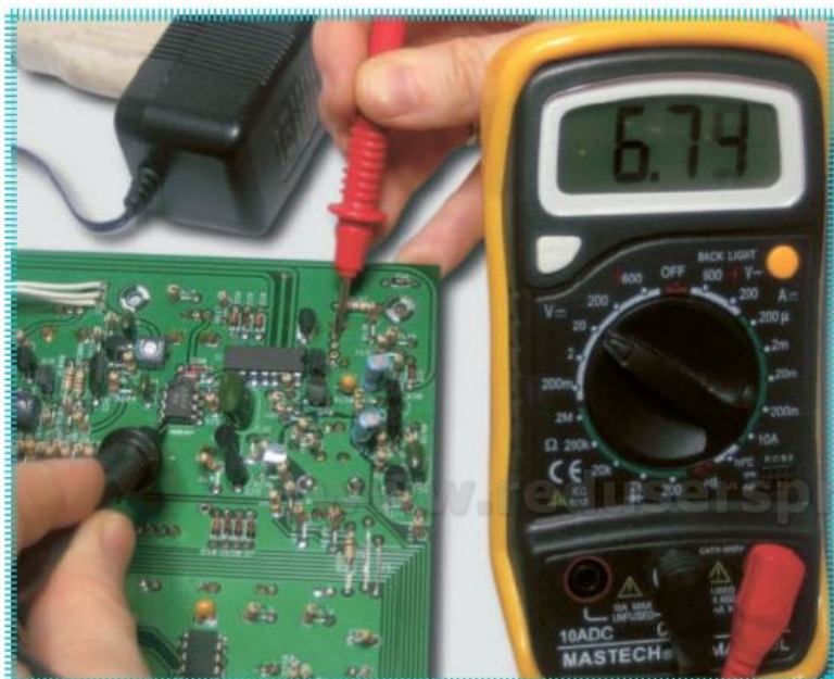
Observamos la rueda de selección de un multímetro digital con todos los alcances y tipos de medición posibles de realizar.
