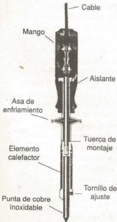
Figura 16-28. Partes de un cautín eléctrico de calentamiento por resistencia.
