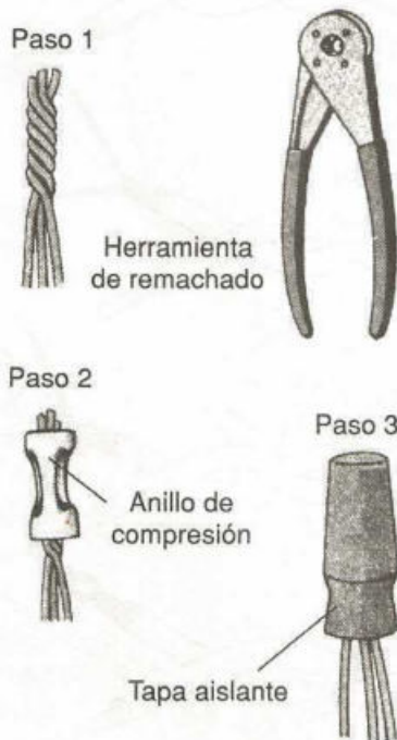
Figura 17-19. Forma de colocar un anillo de compresión
