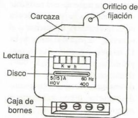
Figura 18-53. Partes de un contador de energía
