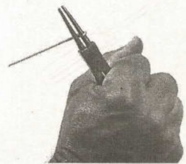
Figura 16-8. Forma de utilizar las puntas redondas para hacer ojales
