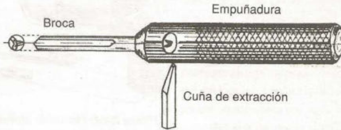
Figura 16-52. Partes de un barreno de empuñadura desmontable
