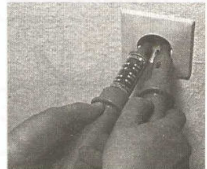
(b) Medición del voltaje de línea con un probador bipolar estilo europeo
