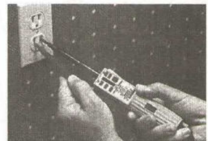
(c) Medición del voltaje de línea con un probador bipolar estilo americano
