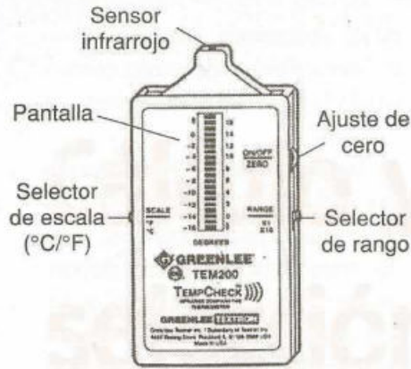
Figura 18-60. Partes de un termómetro infrarrojo
