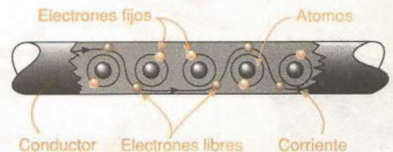
Figura II-1. Una corriente eléctrica se origina como consecuencia del movimiento de los electrones libres a través de un material.
