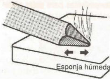
Figura 16-33. La punta de un cautín debe siempre conservarse limpia frotándola sobre una esponja húmeda.
