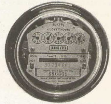
Figura I3-15, Contador de energía residencial
