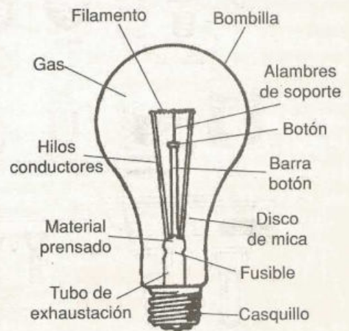
Figura 15-64. Estructura de una lámpara incandescente
