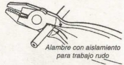
Figura 16-7. Forma de utilizar las pinzas universales para pelar alambres
