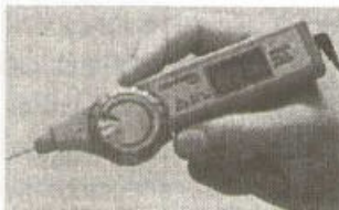
• Forma de utilizar un multímetro tipo lápiz
