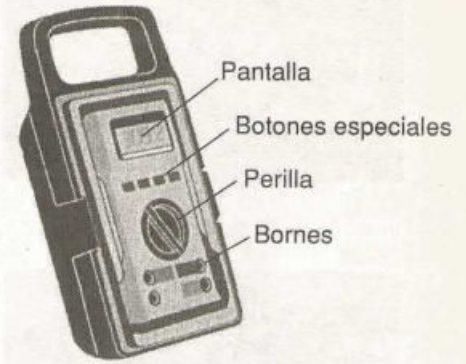
Figura 18-25. Partes de un multímetro digital
