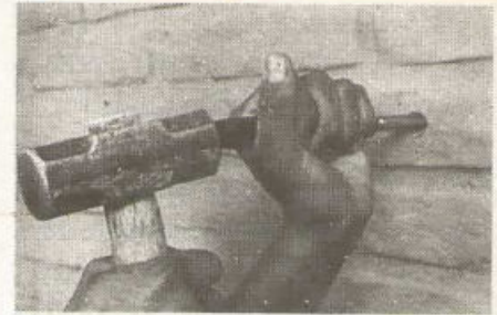
Figura 16-53. Forma de utilizar un barreno de puntas intercambiables
