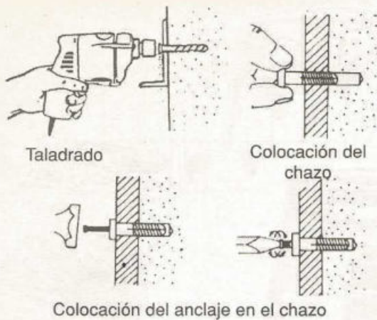
Figura 16-48. Forma de utilizar el taladro para colocar chazos o taquetes
