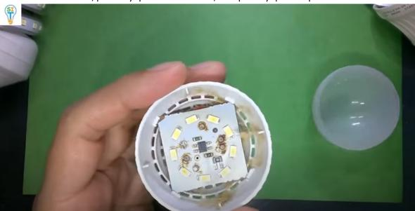
Se levanta la placa con un destornillador y se observa que el capacitor se estalló.
