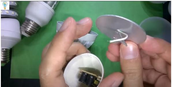
Segunda razón, es la forma como están diseñadas estas lámparas, porque los Led al estar trabajando a esa temperatura su vida útil se va deteriorando, ya que está trabajando a nivel máximo y como no tiene disipación más rápido se dañan.
