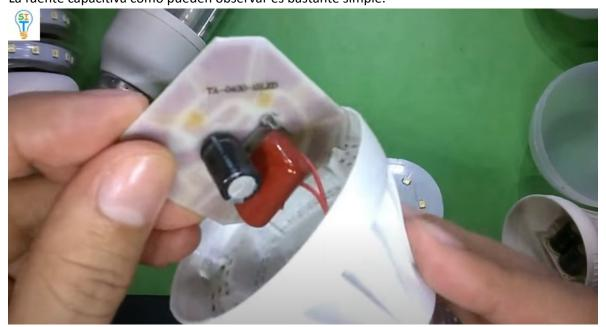
Si se fijan en el diagrama una de las desventajas que tiene es que el voltaje de entrada está muy relacionado con el voltaje de salida, no hay ningún elemento que los aislé magnéticamente entre la entrada y la salida.
