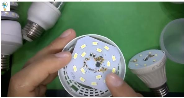
Otro factor es que estas lámparas tienen aquí un capacitor electrolítico y como toda la placa se calienta, el capacitor consume ese calor que irradia hacia abajo.
