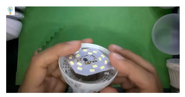
Esta es una lámpara de fuente capacitiva que está dañada, por la parte de arriba aparentemente no se ve nada dañado, pero hay que revisar los Led, siempre hay que comprobar los Led.
