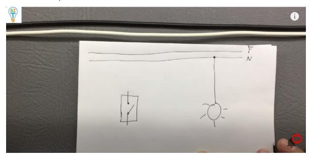
luego voy a conectar también una línea de fase con un extremo del interruptor; bueno entonces aquí tengo ya la fase conectada con el interruptor
