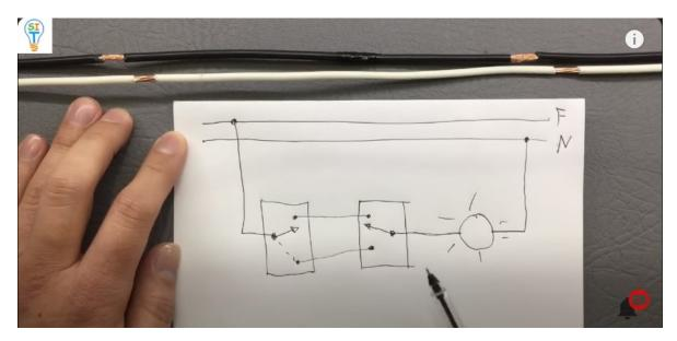
entonces de esta forma si cumplimos con lo que hemos venido haciendo, fíjense, si esto está apagado por alguna razón, si por aquí no llega energía, la lámpara va a estar completamente des energizada porque va a estar con el neutro
