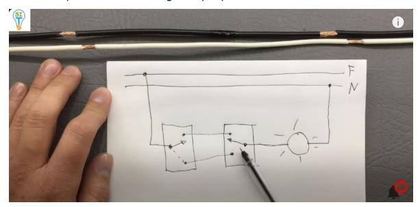
y cuando por aquí le llegue energía entonces encenderá. ¿cómo llega energía hacia acá? muy fácil vamos a suponer que estamos conectados hacia la parte de arriba
