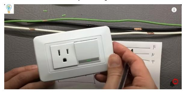
Entonces, aquí tenemos el interruptor para controlar esta lámpara, o este foco, una parte de este interruptor tiene que ir con la línea de fase, entonces, simplemente aquí tomamos la línea de fase y en el otro extremo por dónde sale ese interruptor lo llevamos hacia el foco y este sería la conexión para un toma y un interruptor que están unidos
