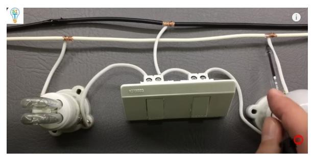
las dos lámparas, los focos, terminan en neutro. Se conecta a fase es a través de un interruptor. Pues entonces vamos a hacer la prueba, ya energicé las dos líneas entonces vamos a probarlo; fíjense si enciendo acá se enciente este foco, el de la derecha
