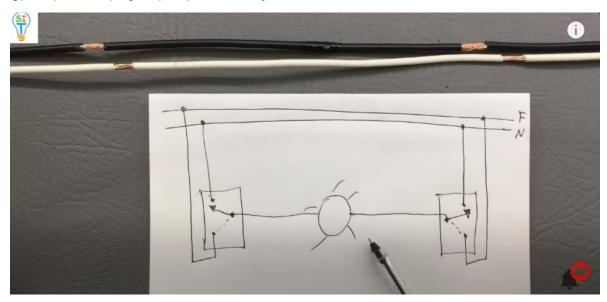
pero a pesar de que está apagado en los extremos de la base del foco va a llegar el voltaje de fase, un alto voltaje, entonces esto realmente es un problema porque se podría pensar que no hay energía; entonces, por esta razón este esquema es riesgoso y este es el problema que trae.
