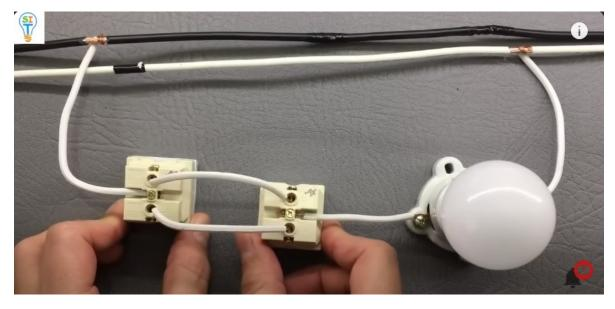
que es que entra en el medio del primer interruptor de conmutación y de los dos extremos salen a los siguientes dos extremos del otro interruptor y del medio otra vez vuelve a salir hacia el foco
