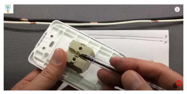
entonces estos son los tipos interruptores que vamos a usar para este esquema. Entonces, cómo sería este esquema; sería así: un cable directamente al neutro
