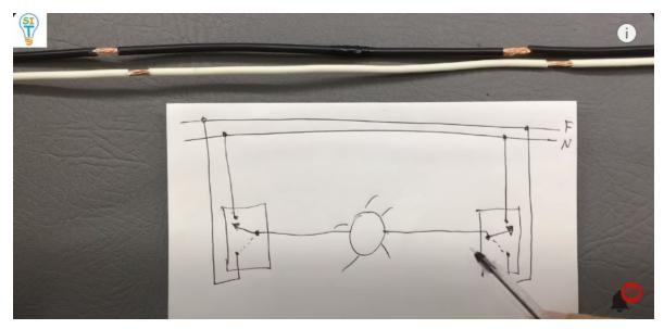
pueden observar que la lámpara se controla por los dos interruptores si ustedes se han dado cuenta en los otros esquemas anteriores yo siempre les he dicho que el control debe ser siempre por el lado de fase y resulta que aquí no se cumple eso, porque, en este lado, en algún momento puede estar la fase
