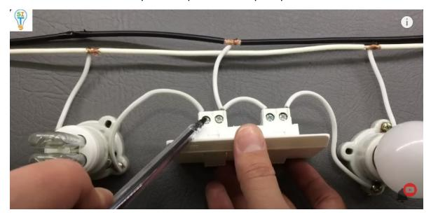
la otra parte el interruptor está común con el otro interruptor, fíjense queda una sola línea que viene de fase
