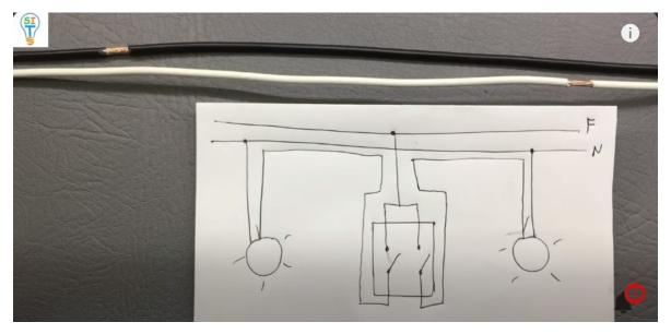
y aquí tenemos el esquema de un interruptor doble que controla dos lámparas de forma independiente, o sea, este interruptor no tiene nada que ver con este
