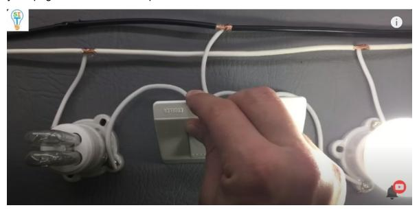
igual éste. Bueno entonces ahora vamos con otro esquema, que es el esquema típico de escalera, donde nosotros vamos a controlar un foco desde dos puntos diferentes con dos interruptores diferentes.
