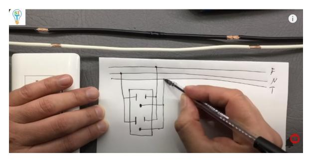
Entonces, ese sería la conexión de un toma doble, por ejemplo, si nosotros vemos está acá éste toma ya internamente está conectado
