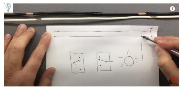
y luego el otro extremo, que es la parte de control, la vamos a conectar con el centro de uno de los interruptores y luego estas partes de los interruptores la vamos a conectar entre sí
