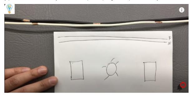
este el clásico circuito de escalera donde un interruptor está en la parte de abajo de la escalera y el otro está en la parte de arriba, ahora, en este caso, los interruptores que vamos a usar para poder controlar una lámpara desde dos lugares diferentes se llaman interruptores three way o interruptores de conmutación. Fíjense cuál es la diferencia; estos interruptores no son simples son de esta manera: tienen un contacto que pivotea de este punto a este.
