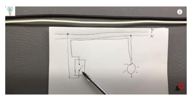
con este interruptor conectado a la fase el otro extremo sale para el otro extremo del foco
