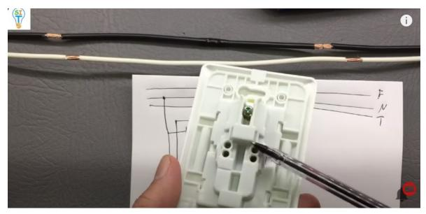
lo que es el neutro, los dos neutros están conectados, fíjense por este lado está conectado aquí y la línea o la fase está conectado por aquí y la tierra está conectado toda internamente y sólo tiene un punto de conexión
