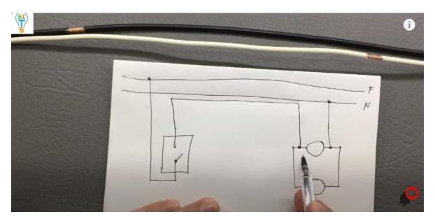
justo este es el esquema para un interruptor y dos focos, se deben colocar en paralelo
