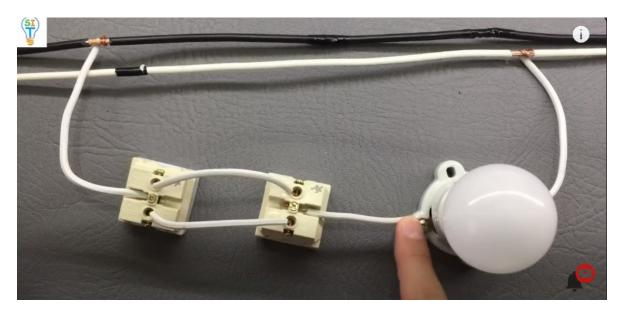
entonces vamos a voltearlo para hacer la demostración cómo funciona. Energice y ahora vamos a hacer la prueba fíjense debería controlar el foco desde los dos interruptores como en el caso anterior aquí encendemos y apagamos
