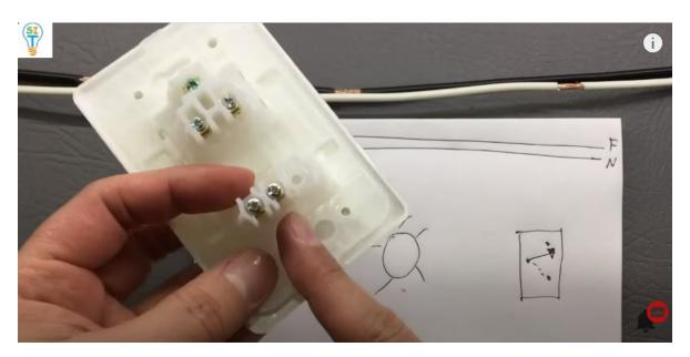
fíjense el solamente prende y apaga o se conecta aquí y desconecta; en cambio, el three way desde el medio conecta para acá o conecta para acá
