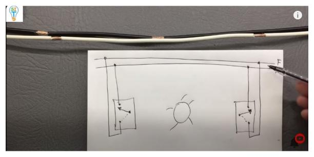
y el que está en el medio es justamente el que se va a conectar por un extremo del foco y del otro extremo va a llegar al medio del otro interruptor
