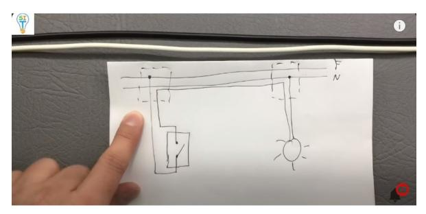
estos serían dos cajetines de intersección de cables. Bueno entonces ahora vamos a conectar esto con un interruptor real y una lámpara para ponerlo a funcionar. Entonces aquí tengo mi interruptor simple y mi foco o lámpara
