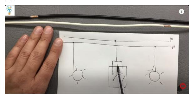
y aquí tenemos la conexión, una conexión, un cable, que nos llega a este interruptor doble; un lado del interruptor, va a subir por la misma canalización, digamos así, por el mismo tubo, y va a conectar hacia un foco
