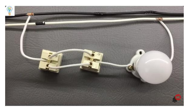
entonces como ustedes pueden ver ya tengo conectado aquí los dos interruptores con la lámpara o el foco fíjense que está conectado en el neutro o extremo del foco y el otro extremo, que es la parte de la fase, viene hacia los dos interruptores de esta forma como están aquí
