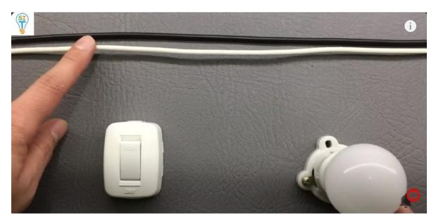
entonces tal como lo hice en el esquema voy a tomar del neutro y conectó hacia un extremo de la lámpara y de la fase voy a conectar hacia un extremo del interruptor y el otro extremo se va a venir hacia el otro extremo del foco o la lámpara y ya le muestro cómo va a quedar
