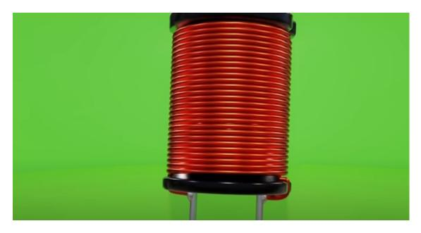
El inductor o bobina es un componente electrónico capaz de almacenar energía
